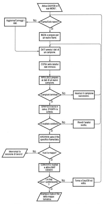
Fig. 2 Diagramma del flusso di operazioni della procedura di funzionamento del modulo EBI sulla valutazione della qualità biologica dei corsi d'acqua. Esso è stato realizzato utilizzando il software originale EASYEBI e dall'applicativo MAPVIEWER.
