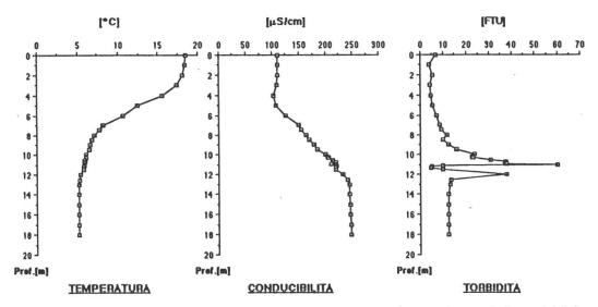
Fig. 2 Profili dei valori della temperatura, della conducibilità elettrica e della torbidità sulla colonna d'acqua del Lago di Cadagno. Valori misurati il 28 luglio 1992.
