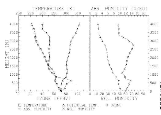
Abb. 4. Daten des Freiballonaufstiegs vom 10.9. 1982 um 17.00 Uhr. Startort: Merenschwand. (Höhen in Meter über lokalem Grund; relative Luftfeuchtigkeit in %.)
