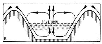
Abb. 7. Schematische Darstellung eines in hügeligem Gelände auftretenden Hangwindsystems (A: Tag, B: Nacht).
