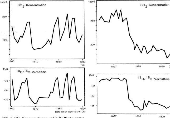
Abb. 6.  $\rm CO_2$ -Konzentrationen und  $\delta^{18}\rm O$ -Werte, gemessen an Eisproben von Dye 3. Die 30m entsprechen ungefähr 10000 Jahren (Stauffer et al. 1983). Die Kurve verbindet bei den  $\rm CO_2$ -Konzentrationen Mittelwerte mehrerer Messungen der gleichen Tiefe, bei den  $\delta^{18}\rm O$ -Werten einzelne Messresultete.
