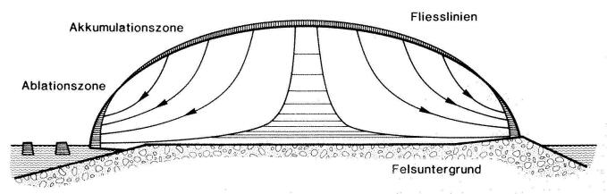
Abb. 1. Schematischer Querschnitt durch einen Eisschild. Vom zentralen Gebiet mit Eiszuwachs (Akkumulationszone) fliesst Eis gegen die Küste hin, wo es in der Ablationszone abschmilzt oder am Rand als Eisberg ins Meer abbricht.
