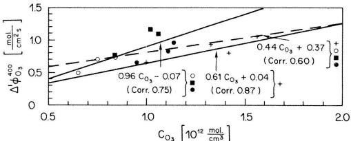
Abb. 6. Ozonzerstörungsrate (x 10-12) im Zeitraum von 18 bis 06 Uhr in der Schicht 0-400 m nach Abzug des Anteils der homogenen Chemie, abgetragen gegen die mittlere nächtliche Ozonkonzentration in derselben Schicht.
