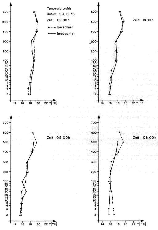
Abb. 6. Vergleich gemessener und berechneter Temperaturprofile am 23.6.1976 zu verschiedenen Zeitpunkten. Beginn der Rechnung am 22.6.1976 um 10.00 h.
