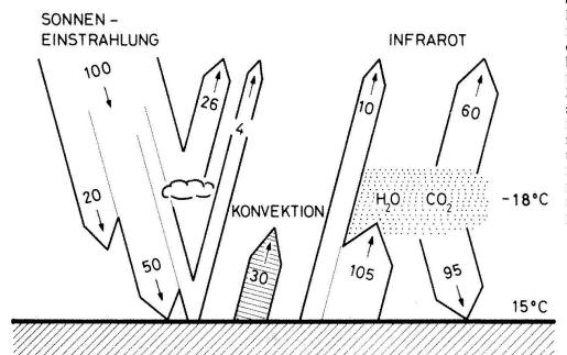
Abb. 2 Energiehaushalt Erde: Sonneneinstrahlung am obern Rand der Atmosphäre = 100 Einheiten. Die wolken-Atmosphäre durchlässig für Sonnenlicht, aber nur teilweise Infrarotstrahlung. für Zusätzlich zur Sonneneinstrahlung erhält die Oberfläche Infrarot - = Wärmestrahlung aus der Atmosphäre (Treibhauseffekt). Ausstrahlungstemperatur der Erde: -18°C, mittlere Oberflächentemperatur: +15°C.
