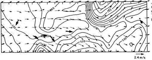
Abb. 7. Vergleich des berechneten Temperaturfeldes 8 m über Boden mit Temperaturmessungen (23.6.1976, 10.00 h).
