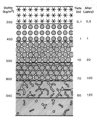
Abb. 2. Schematische Darstellung der Eisbildung durch Sintern von trockenem Schnee. Die Werte für die Dichte gelten allgemein. Die Tiefen und die Alter der verschiedenen Studien variieren sehr stark und hängen vor allem von der jährlichen Akkumulationsrate und von der mittleren Temperatur ab. Die angegebenen Werte gelten ungefähr für Dye 3.
