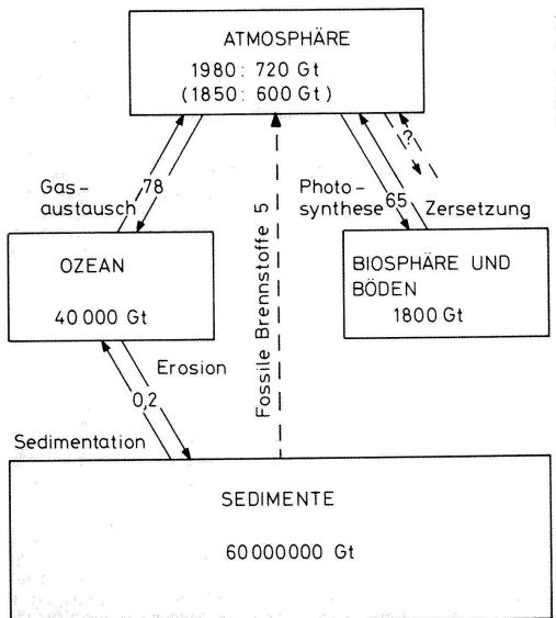
Abb. 4 Kohlenstoffreservoirs und Austauschflüsse. Mengen in Gt C (1 Gt = 1 Gigatonne = 10 t), Flüsse in Gt C/a. Ausgezogene Pfeile: natürliche Flüsse; gestrichelte Pfeile: zusätzliche Flüsse.
