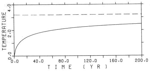
Abb. 3 Modellmässig berechneter Temperaturanstieg für eine plötzliche CO<sub>2</sub>-Verdoppelung zur Zeit 0. Gestrichelt: für Strahlungsgleichgewicht (+3,2 K); ausgezogen: unter Berücksichtigung der Wärmekapazität des Ozeans (Siegenthaler und Oeschger 1984).
