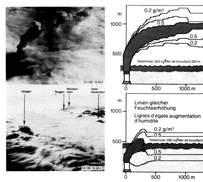
Abb. 4. Verhalten des Schwadens des Kernkraftwerkes Gösgen bei einer winterlichen Hochdrucklage mit Nebelmeer über dem Mittelland. Die obere Figur zeigt die Fotografie eines die relativ tiefliegende Nebeldecke durchstossenden Schwadens und dessen Nachrechnung
