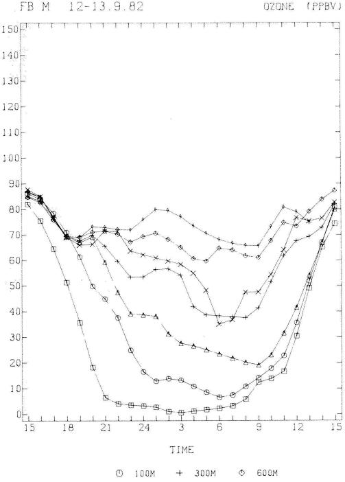
(PPBV) Abb. 5. Ozontagesgänge am 12./13.9.1982 in verschiedenen Höhen über Merenschwand. (Fesselballondaten; Höhen in Meter über lokalem Grund.)
