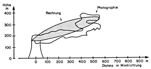
Abb. 3. Vergleich beobachteter mit berechneten Schwaden nach F. Gassmann und M. Tinguely (1982).Die Rechnung wurde unter Verwendung einer am Standort ge-Sondierung machten durchgeführt. Die obere Figur zeigt einen Schwaden mit nicht genau angebbarer Länge, da sie sich mit einer tiefliegenden, geschlossenen Wolkendecke vereinigt.
