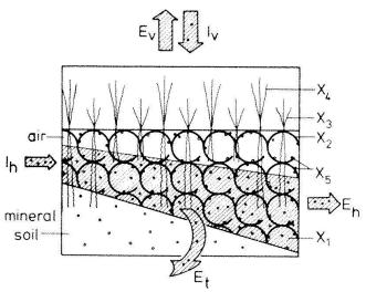
Fig. 1: Die wichtigsten Elemente des Moormodelles:  $X_1$  – Wasser,  $X_2$  – Torf,  $X_3$  und  $X_4$  – Hoch- und Zwischenmoorpflanzen unterschiedlicher Wurzelungstiefe,  $X_5$  – Nährstoffe.  $E_v$  und  $I_v$  – vertikaler Export und Import,  $I_h$  und  $E_h$  – horizontaler Transport,  $E_t$  – lateraler Transport (nach Wildi 1978).
