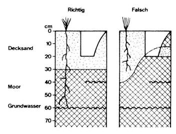
Abbildung 5: Schematischer Profilschnitt: Richtig übersandet und zu schwach übersandet bei unebener Mooroberfläche.
