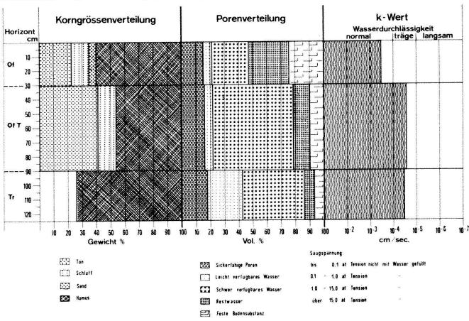
Abbildung 1: Physikalischer Aufbau eines tieftorfigen Halbmoores.
