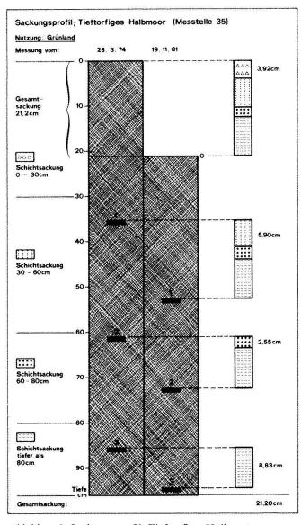
Abbildung 3: Sackungsprofil; Tieftorfiges Halbmoor.
