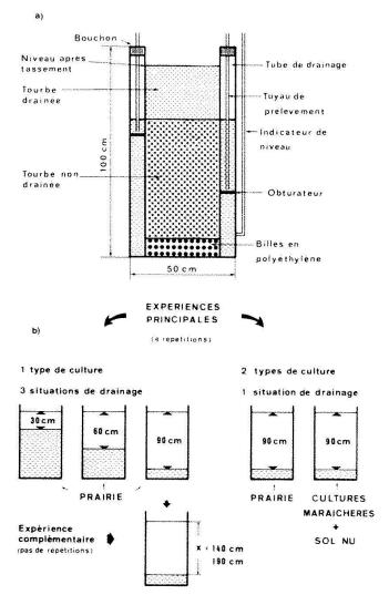
Figure 1. Dispositif expérimental.
