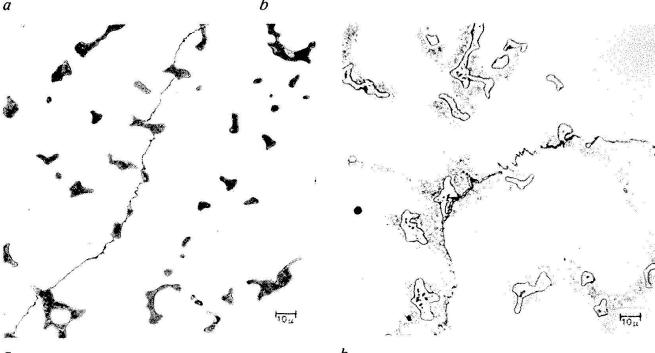
Abb. 11. Mikrogefüge der CoCrMo-Gusslegierung (ISO 5832-4).
