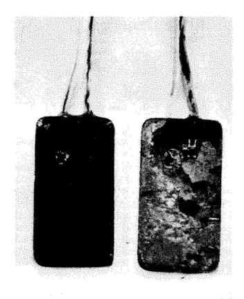
Abb. 2. Metallplättchen der in vivo Korrosionsmessungen, explantiert nach etwa 2 Monaten. Gewebereste kleben an den leicht angegriffenen Oberflächen. Ein isolierter Kontaktdraht und die in die Oberfläche mündende Salzbrücke zur Referenzelektrode werden durch die Haut geführt.
