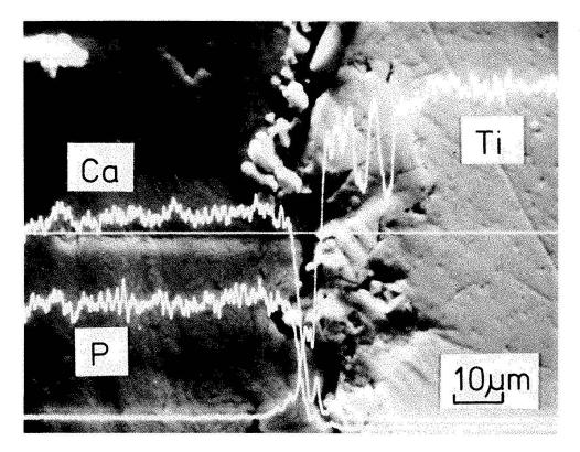
Abb. 4. Rasterelektronenmikroskopisches Bild des Kontaktbereiches schen Knochen und Zahnimplantat mit den Konzentrationsprofilen Titan, Kalzium und Phosphor. Die Implantatoberfläche mit der Plasmaspritzschicht ist rauh. Der Knochen wächst in die rauhe Oberfläche ein, und die Konzentrationsprofile längs der Linie (in der Mitte) zeigen den unmittelbaren Kontakt.
