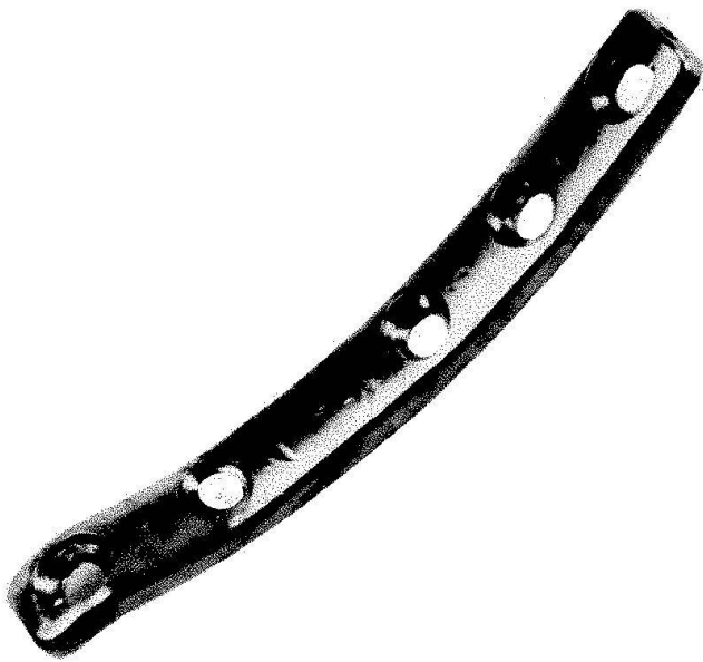
Abb. 5. Eine explantierte Platte weist im schlimmsten Fall die hier gezeigten Kratzer, Kerben und Biegungen auf. Die Form der Knochenoberfläche bedingt, dass der Chirurg das «forgiving metal» benötigt.
