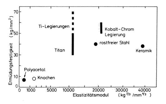
Abb. 4. Festigkeit Elastizitätsmodul Knochen und Implantatmaterialien (Ermüdungsfestigkeit für Metalle, Reissfestigkeit für Polyacetal, Zugfestigkeit für Aluminiumoxid; Daten für Stahl, Titan und Ti-Legierung Steinemann Kobalt-Legie-1980, für rung Semlitsch 1976).
