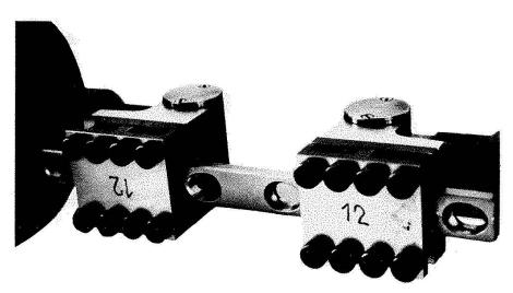
Abb. 2. Knochenplatte im Ermüdungsversuch; in wechselnder Beanspruchung wird die Platte verbogen.
