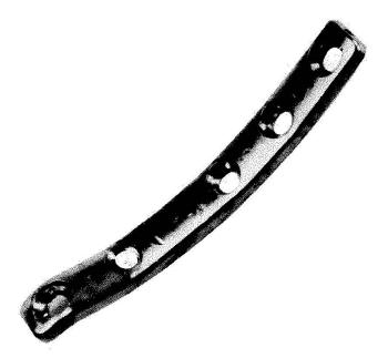
Abb. 5. Eine explantierte Platte weist im schlimmsten Fall die hier gezeigten Kratzer, Kerben und Biegungen auf. Die Form der Knochenoberfläche bedingt, dass der Chirurge das «forgiving metal» benötigt.
