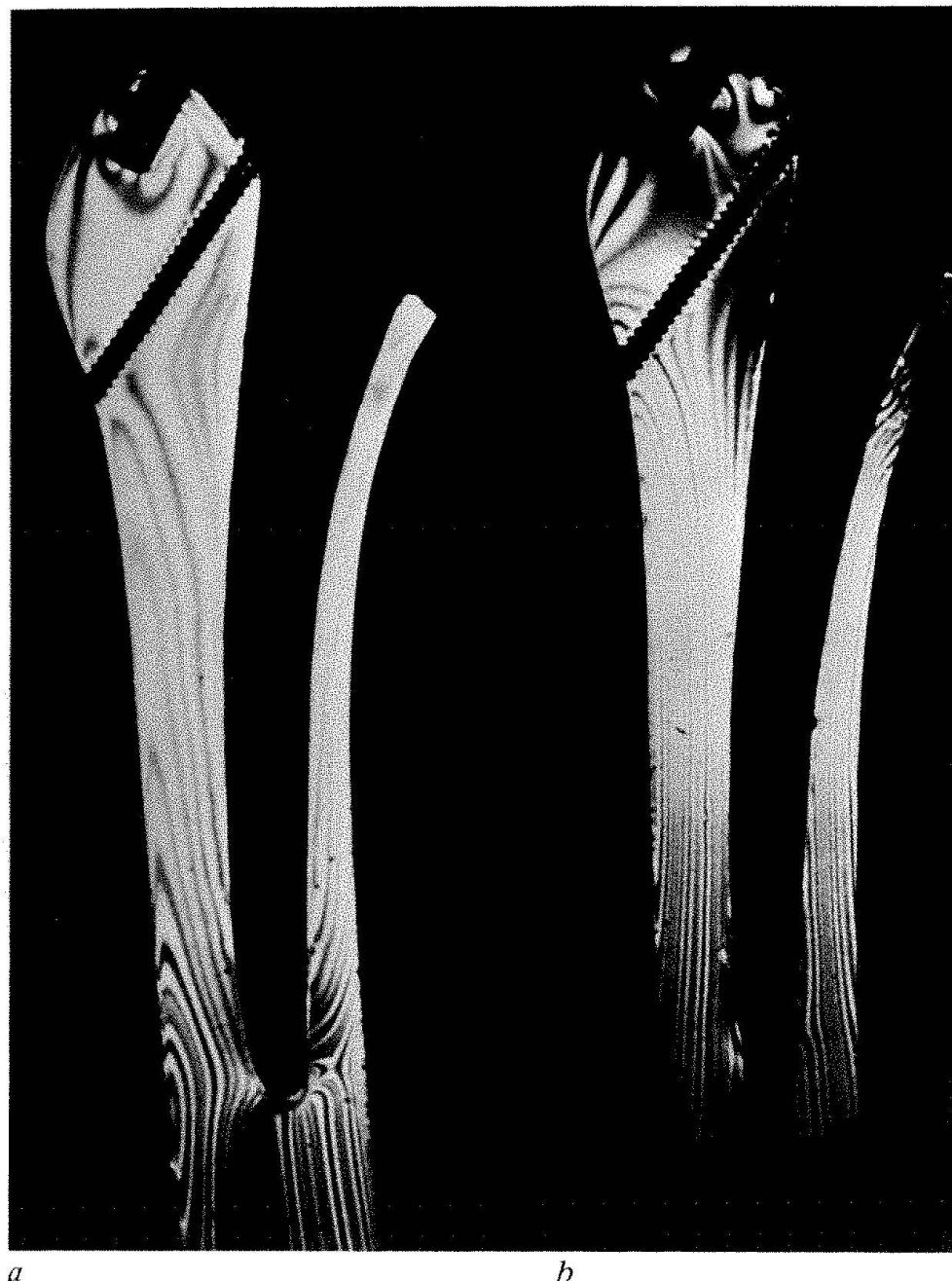
Abb. 2. Spannungsoptik des proximalen Femur- endes unter Belastung a) mit Metallprothese, b) mit isoelektischer Pro- these.
