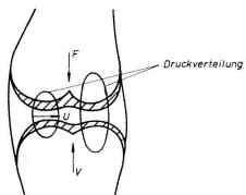
können Reste von Synovia, Synoviapfützen, auch unter hohen Drücken gefangen bleiben und damit die Reibung herabsetzen. Dieser Mechanismus wird als «boosted lubrication» bezeichnet.
