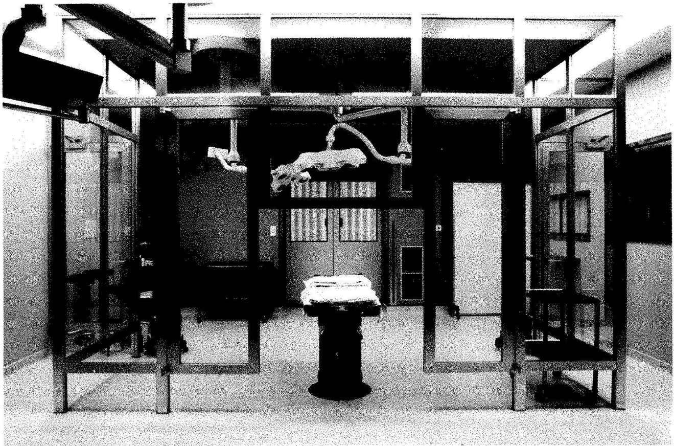
Abb. 2.b) Ansicht des unterteilten Operationssaals. Der Kopf des Patienten und das Anästhesieteam bleiben ausserhalb der hochaseptischen Zone.
