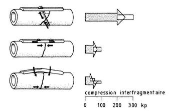
Fig. 3. Compression obtenue avec une plaque utilisant diverses méthodes.
