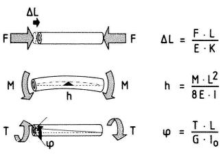
Fig. 1. Relations entre les charges appliquées à l'os et les déformations qui en résultent.
