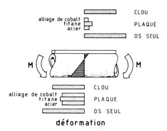
Fig. 4. Déformation à la surface d'un os sollicité en flexion. La déformation de l'os intact est prise comme référence; la déformation d'un os ostéosynthèse par plaque est fortement réduite sous la plaque, plus faiblement du côté opposé; la déformation d'un os encloué est plus faiblement réduite. L'influence du choix du métal (acier, titane ou alliage de cobalt) pour la plaque est marquée, mais pas si importante qu'on pourrait le croire.
