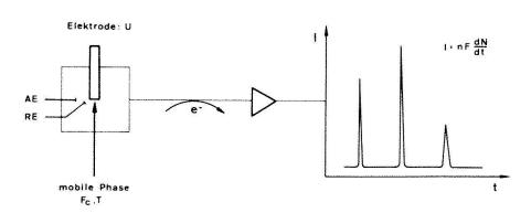
oder Aminogruppe aufweisen. Andererseits kann die Selektivität innerhalb dieser Stoffklassen durch geeignete Wahl der Polarisationsspannung für bestimmte Verbindungen vergrössert werden. Je niedriger die Spannung gewählt werden kann, umso selektiver ist die Detektion (Abb. 3).
