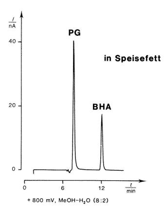
Abb. 10. Bestimmung von Propylgallat und Butylhydroxianisol in Speisefett. Stationäre Phase: LiChrosorb RP-18,  $5\mu m$ , Eluent: Methanol-Wasser (8:2) mit Lithiumperchlorat und Essigsäure ( $\rho$ (LiClO<sub>4</sub>) = 2 g/l,  $\rho$ (HAc) = 5 g/l)  $F_c$  = 0,5 ml/min. Detektion:  $U_{Pol}$  = +800 mV, I = 10 nA.
