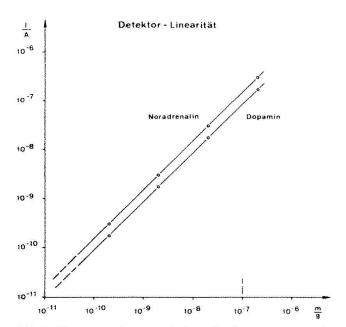
*Abb. 2.* Zusammenhang zwischen Probenmengen und Detektorsignal. Die Probemenge sollte 100 ng nicht übersteigen. Stationäre Phase: RP-18, 5  $\mu$ m, wässeriger Eluent pH 3,2,  $U_{Pol} = +800$  mV,  $F_c = 1$  ml/min.
