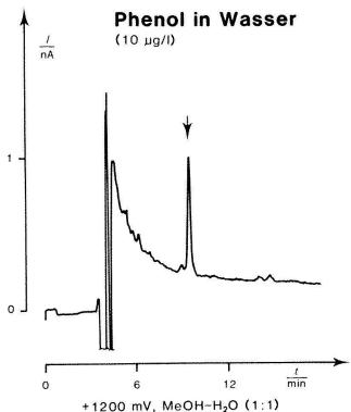
Abb. 8. Bestimmung von Phenol aus Abwasser: =  $10 \mu g/1$ .
