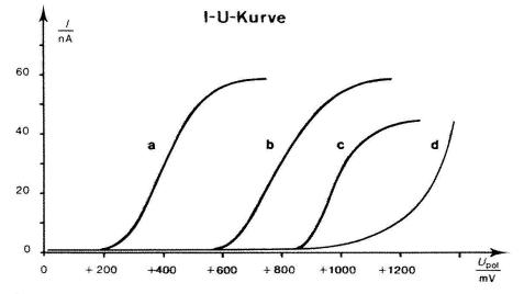
Abb. 3. Hydrodynamische Stromspannungskurven: a: Ascorbinsäure, b: Noradrenalin, c: Tryptophan, d: Grundstrom (Wasser, pH 3.2). Stationäre Phase: RP-18. 5  $\mu$ m,  $F_c = 1$  ml/min.
