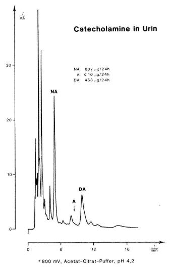
Abb. 5. Catecholaminbestimmung aus Urin: L-Noradrenalin (NA), Adrenalin (A) und Dopamin (DA), Probenaufbereitung über Alox. Stationäre Phase: Nucelosil 10 SA, 10 μm (Kationenaustauscher), Eluent: Acetat-Citrat-Puffer, pH 4.2 ( $\rho$ (C<sub>6</sub>H<sub>8</sub>O<sub>7</sub>·H<sub>2</sub>O = 5,7 g/l,  $\rho$ (CH<sub>3</sub>COONa·3H<sub>2</sub>O) = 6.8 g/l,  $\rho$ (NaOH) = 2,4 g/l,  $\rho$ (HAc) = 10 g/l), F<sub>c</sub> = 2 ml/min. Detektion: U<sub>Pol</sub> = +800 mV, I = 50 nA.
