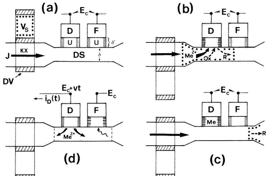
Abb. 1. Funktionsprinzip der coulometrischen Dünnschicht-Durchflusszelle zur Metallbestimmung. Erklärungen im Text.
