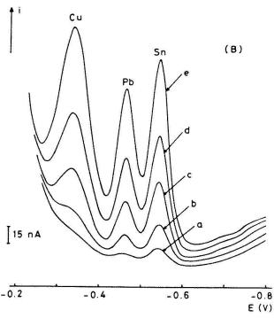
Fig. 1. Polarogrammes typiques obtenus par polarographie inverse alternative. Temps de pré-électrolyse: 1 min. Concentration de Sn, Pb et Cu: a) blanc, b) 2 ppb, c) 4 ppb, d) 10 ppb, e) 20 ppb. (A) en absence de Lumatom\*; (B) en présence de 2,5% (poids/volume) de Lumatom\*.
