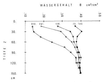
Abb. I. Wassergehaltsprofile 1978 im mit Gras bepflanzten, gedüngten Lysimeter.
