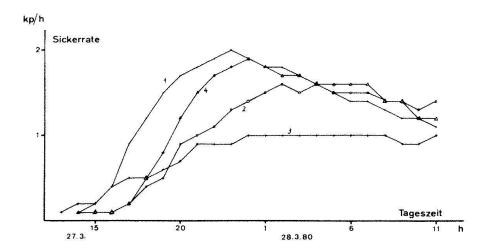
Fig. 1. Stündliche Sickerrate der vier Lysimeter: Typischer Verlauf nach starkem Niederschlag, 3,1 m² Lysimeterfläche
