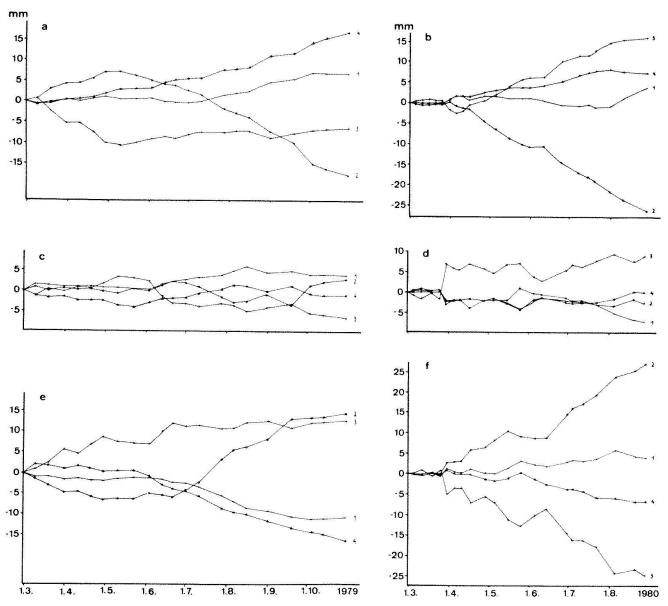
Fig. 3a-f. Verläufe der kumulierten Abweichungen der Messgrössen vom jeweiligen Mittelwert aus den täglichen Werten der vier Lysimeter. Linke Hälfte, Messperiode 1979; rechte Hälfte, Messperiode 1980. a und b: Sickerrate; c und d: Gewichtsänderung; e und f: Evapotranspiration. Die Nummern am rechten Rand bezeichnen die vier Lysimeter.
