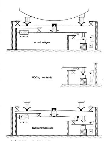
Abb. 3. Schema der Lysimeterwägung.
