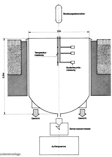
*Abb.* 2. Messgeräteausstattung der Lysimeteranlage.
