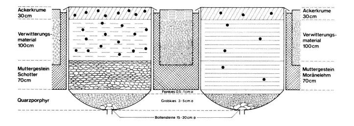
Abb. I. Aufbau der Lysimeter.
