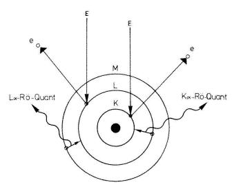
Fig. 2. Schematische Darstellung der Entstehung charakteristischer Röntgenstrahlen beim Beschuss eines Objektatoms mit Strahlelektronen.
