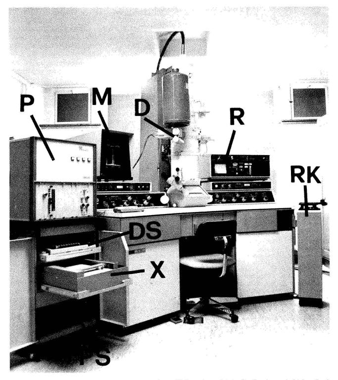
Fig. 3. JEOL 100-CX STEM – Mikroskop mit integrierter EDX-Analyseneinheit. D= Detektor mit Stickstoffspeichergefäss; P= Pulsprocessor; X = X-Y-Schreiber: DS= Digitalschreiber; M = Monitor; PS= Plattenspeicher; R = Rastereinheit; RK = Rasterkamera.
