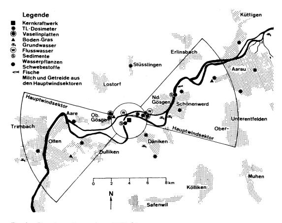
Fig. 2 Umgebungsüberwachung KKW Gösgen
