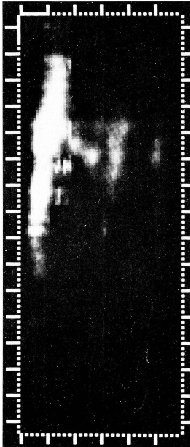
Abb. 7 Aufbelichtung der digitalen Daten mittels einer Optronics „Photomation Mark II“-Anlage. Jedes Einheitsviereck stellt einen Wert in 8 bit (256 Graustufen) dar. Es wurde die gleiche Darstellungsart wie in Bild 3 gewählt: die Frequenz geht von 236 MHz (oben) bis 394 MHz (unten), die Zeit von 1036.46 bis 1038.55,6 WZ (aus Benz und Asper, 1975).
