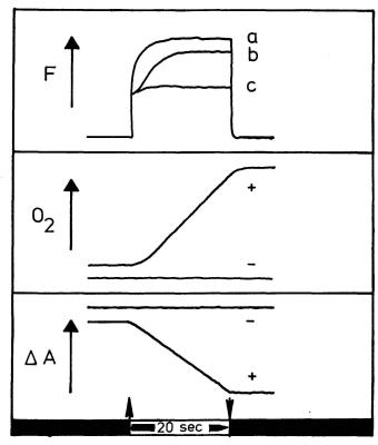
Fig. 3 Das simultane Erfassen von variabler Fluoreszenz (F), Sauerstoffkonzentration und Absorptionsänderungen ( $\Delta A$ ) in der Absorptionsbande des verwendeten Elektronenakzeptors.  $\uparrow$  Licht aus a, b, c sind drei verschiedene Kurventypen der variablen Fluoreszenz
