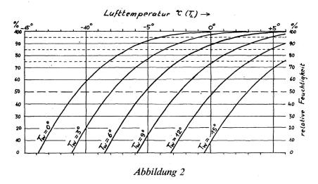
Grenzbedingung für Mischungsnebel über Wasserflächen bei verschiedenen Wassertemperaturen  $(T_W)$
