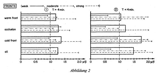
Mittlere Halbtagswerte der relativen Druckamplituden bei Frontdurchgängen. Die Balken bedeuten die Mittelwerte über alle drei Intensitätsstufen
