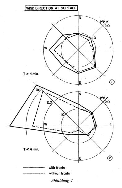
Mittlere relative Druckamplituden in Abhängigkeit der Bodenwindrichtung. Berücksichtigt man nur Tage *ohne* Frontdurchgänge, so erhält man die gestrichelten Kurven
