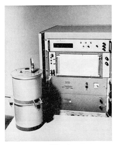
Abbildung 3 Askania-Seegravimeter
