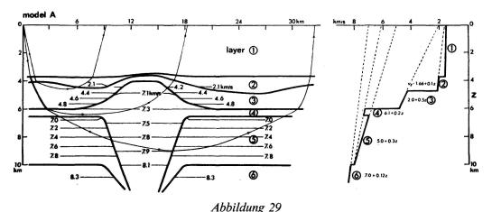
Ergebnis einer refraktionsseismischen Profilmessung in der Norwegischen See, nach Hinz et al. 1 = Wasserschicht, 2 = Sediment, 3, 4 und 5 = vulkanisches Material und basisches Kristallin, 6 = oberer Mantel
