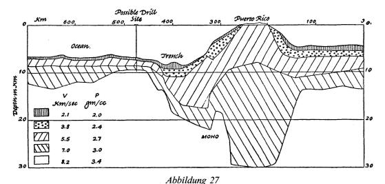
Krustenprofil durch Puerto Rico, den Puerto-Rico-Tiefseegraben und den geplanten Ansatzpunkt des Mohole, nach BASCOM
