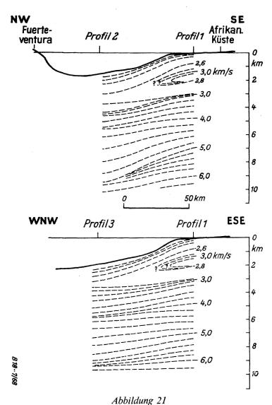
Ergebnisse refraktionsseismischer Profile im Seegebiet zwischen Kanarischen Inseln und Afrika. Es ist der Verlauf von Linien gleicher Geschwindigkeit für longitudinale Wellen als Funktion der Tiefe dargestellt, nach ROESER et al.
