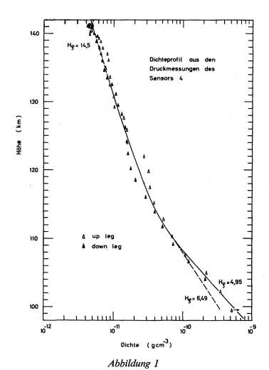
Zenit H1; Flug vom 27.10.1967, 16.45 h MEZ. Dichteprofil der oberen Atmosphäre aus den Messdaten eines geschlossenen Redhead-Manometers (Öffnung des Sensors bei 70 km)
