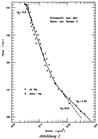
Zenit H1; Flug vom 27.10.1967, 16.45 h MEZ. Dichteprofil der oberen Atmosphäre aus den Messdaten eines offenen Redhead-Manometers
