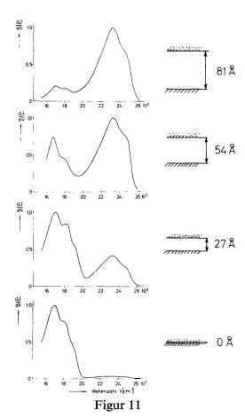
Anordnungen von Schichten von S (Farbstoff I) und A (Farbstoff II) in verschiedenen Abständen d. Fluoreszenzspektren bei Erregung von S durch Bestrahlen des Plättchens mit UV-Licht (366 nm). Mit abnehmendem Abstand d nimmt die Fluoreszenzbande von S ab und die Fluoreszenzbande von A zu
