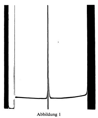
Sedimentationsverhalten von Kalbsherzmyosin (6,6 mg/ml in KCl-Phosphatpuffer) in der Ultrazentrifuge. Aufnahme 2 Stunden nach Versuchsbeginn, Tourenzahl 56100 U./min, Temperatur 20 °C, Schlierenwinkel 70° (Jenny, Waser 1965)
