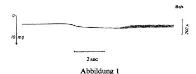
Freie Oszillation eines funktionell isolierten Aktomyosin-Systems (glyzerinierte Muskelfaser von Lethocerus) im ATP-Bad nach Erhöhung der Kalziumionen-Konzentration auf  $10^{-7}$  M; 0,5 cm lange Faser am auxotonischen Hebelsystem. Ionenstärke 0,1  $\mu$ ,
