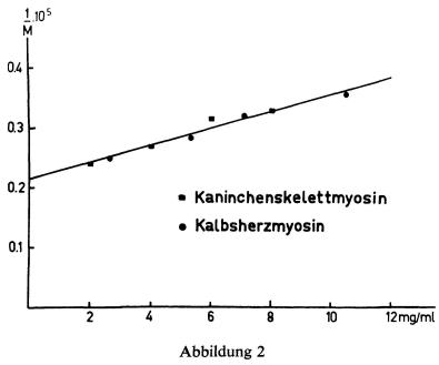
Molekulargewichte von Myosin abhängig von Eiweisskonzentration (Messungen im Sedimentationsgleichgewicht bei 4 °C) (Jenny 1965)
