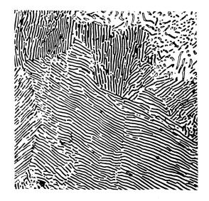
Abb. 5 Mikrophoto eines Metallanschliffes. (Perlit, Ausscheidung von Zementit,  $Fe_3C$ , in  $\alpha$ -Eisen.)
