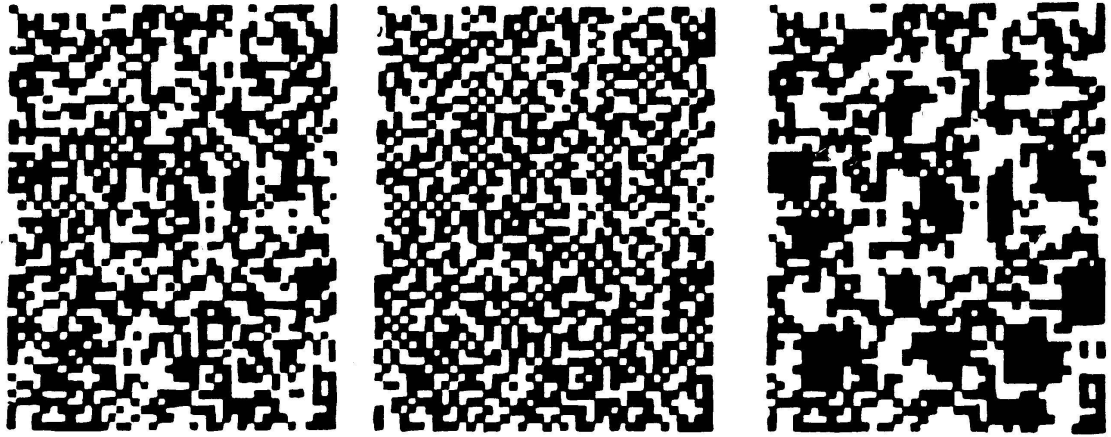
Abb. 9. AB-Anordnungen. Links: zufällige Verteilung. Mitte: willkürliche Abweichung (5 %) von zufälliger Verteilung in Richtung stärkerer Dispergierung; man beachte die Vermehrung und Vergrößerung von «Domänen» geordnet wie in Abb. 8, rechts. Rechts: willkürliche Abweichung (5 %) von zufälliger Verteilung in Richtung stärkerer Koagulation, «Entmischung».
