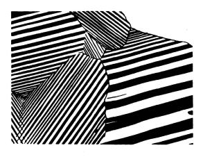
Abb. 6 Zwillingsbildung in In,Tl-Mischkristallen infolge einer beim Abkühlen eintretenden Symmetrieerniedrigung der Kristallstruktur.
