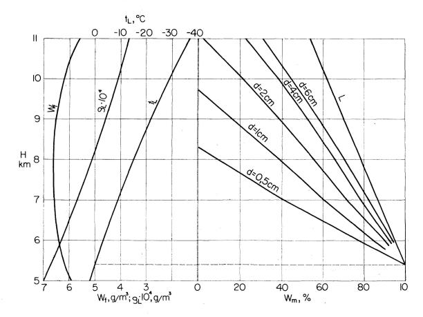
wurde die Temperatur der vereisenden Eiskugel jeweils mit 0°C angenommen. Das Resultat ist aus der Abbildung ersichtlich, die auf der linken Seite die Wolkencharakteristik wiedergibt ( $t_L$  Lufttemperatur,  $w_f$  freier Wassergehalt,  $\varrho_L$  Luftdichte), auf der rechten den zu erwartenden Wasseranteil in Gewichtsprozenten des Ansatzes.
