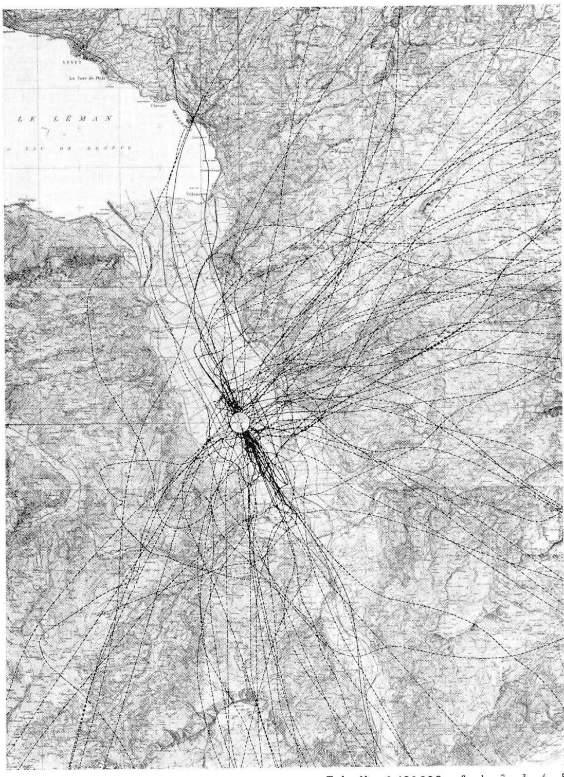
Les lâchers des radiosondes et échosondes à faible vitesse ascensionnelle sont faits au centre du cercle situé approximativement à l'emplacement de la centrale thermique projetée, à l'altitude de 400 m. – Les traits pleins sont les trajectoires du vent entre les altitudes de 400 m et 2000 m, prolongés par des traits interrompus pour les altitudes supérieures.
