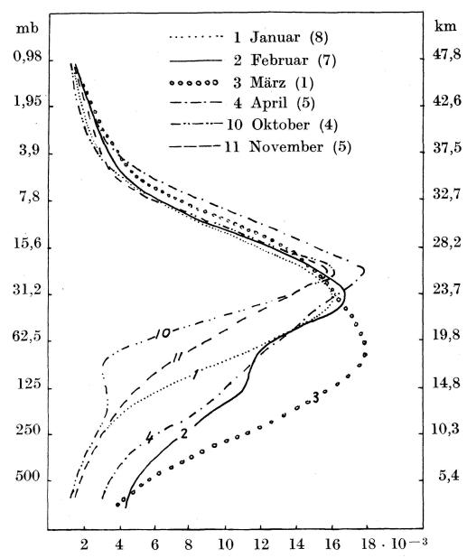
Mittlere vertikale Ozonverteilung für einige Monate in cm  ${\rm O_3/km}$  (neue Skala, Absorptionskoeffizienten nach Vigroux). Die dem Monat in Klammer beigefügte Zahl gibt die Anzahl der im Mittel enthaltenen Einzelfälle. Die gezeichneten Kurven entstanden durch Glättung der berechneten Blockverteilung.
