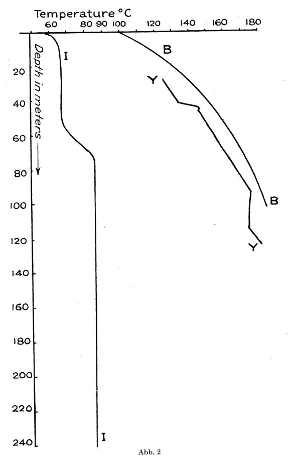
Temperatur-Tiefen-Kurven: I-I, in einem Bohrloch von Sudur Reykir, Island. Y-Y, in einem Bohrloch bei Upper Basin, Yellowstone. B-B, Siedepunkt des Wassers.
