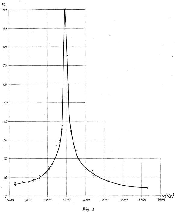
Ausschnitt (Grundschwingung) aus einer mit konst. Kraftamplitude (7,2 g\*) gemessenen Resonanzkurve (Gneis; Tessin).
