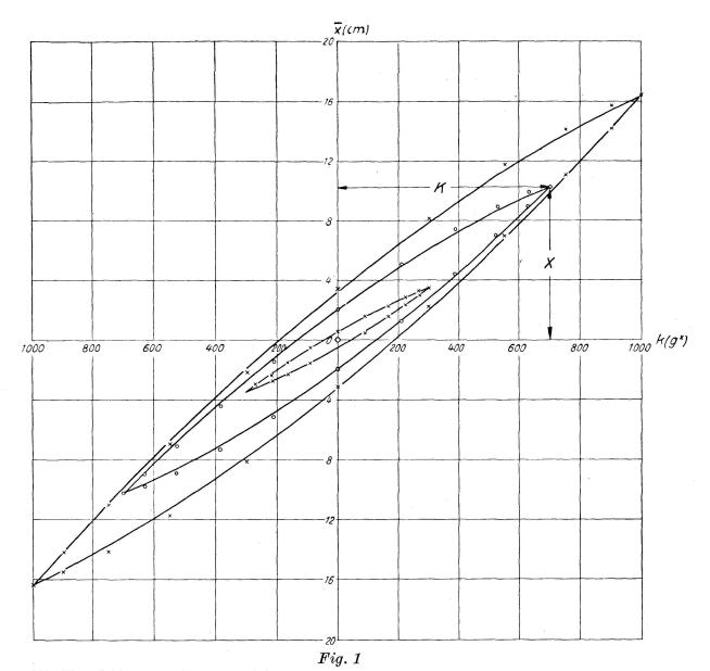
Die Durchbiegung eines einseitig eingespannten Sandsteinstabes (Ostermundigen) in Funktion der eingeprägten Kraft k am freien Stabende  $(T=400~{\rm sec};~\overline{x}=223.x).$
