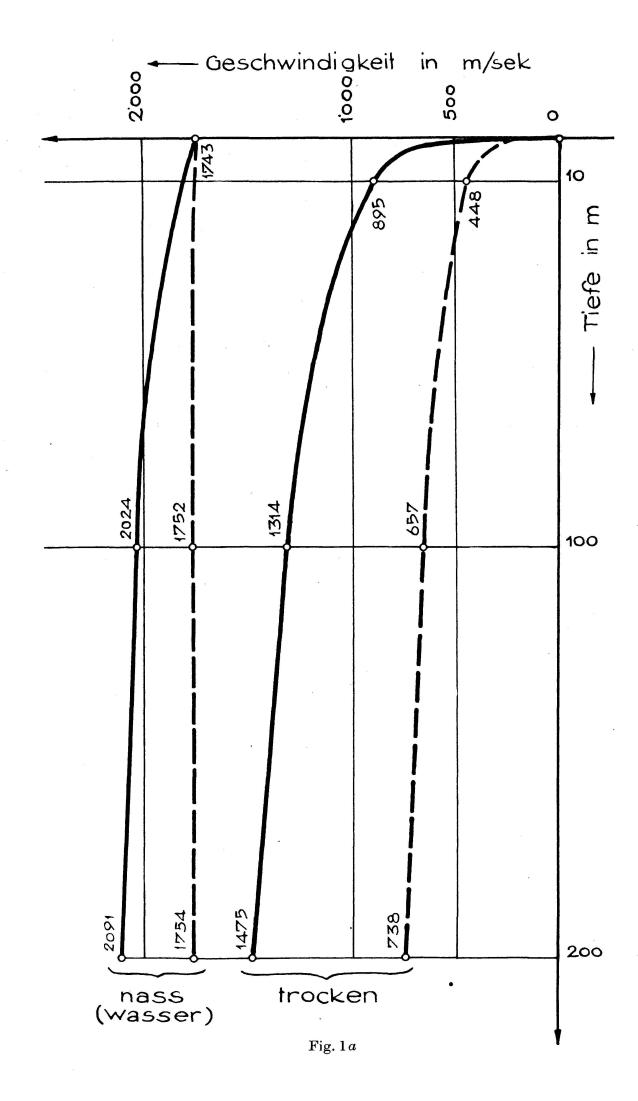
Geschwindigkeiten elastischer Wellen in einer Kugelpackung
