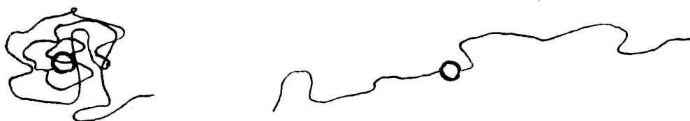
Fig. 11. Dans la pelote, le groupe fonctionnel \bigcirc est masqué (à gauche); dans la chaîne tendue il est exposé aux réactifs (à droite).
