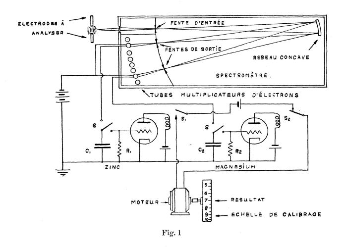
alimenteront deux condensateurs, pendant une trentaine de secondes, et leur charge électrique sera une mesure de l'intensité relative des deux raies. Après cela, la fente du spectromètre se ferme et les deux condensateurs se déchargent sur une résistance appropriée.
