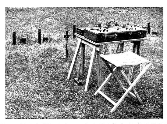
Der geoelektrische Widerstandsmesser des Instituts für Geophysik der E. T. H.
