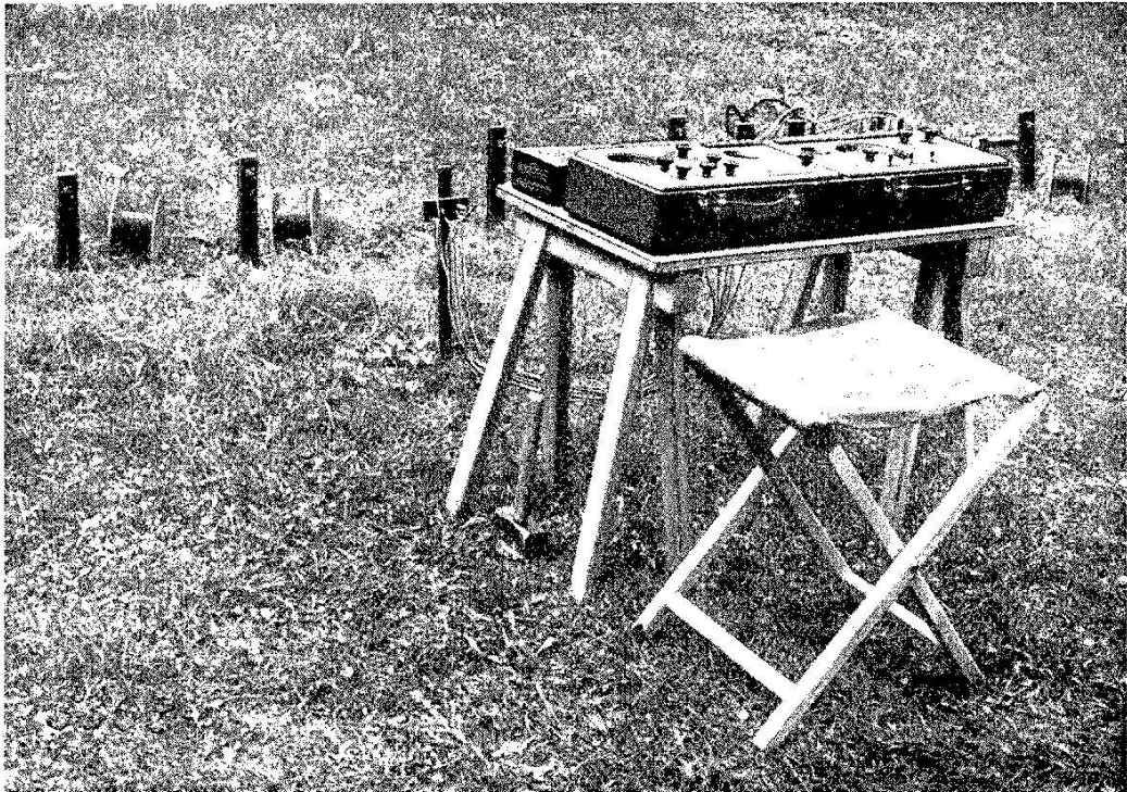
Der geoelektrische Widerstandsmesser des Instituts für Geophysik der E. T. H.
