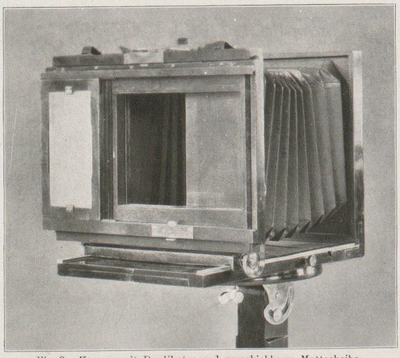
Fig. 3. Kamera mit Duplikator und verschiebbarer Mattscheibe.
