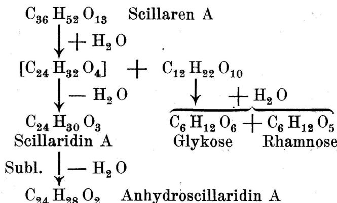
Der Körper  $\text{C}_{24}\text{H}_{32}\text{O}_4$  ist nicht gefasst, er entsteht wohl nur intermediär, verliert aber sogleich 1 Molekül Wasser und geht in  $\text{C}_{24}\text{H}_{30}\text{O}_3$ , das Scillaridin A über, das beim Erhitzen im Hochvakuum auf  $180-200^\circ$  ein Sublimat liefert und dabei unter Verlust eines weiteren Moleküls Wasser in  $\text{C}_{24}\text{H}_{28}\text{O}_2$ , Anhydroscillaridin A übergeht.
