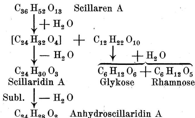
Der Körper C<sub>24</sub>H<sub>32</sub>O<sub>4</sub> ist nicht gefasst, er entsteht wohl nur intermediär, verliert aber sogleich 1 Molekül Wasser und geht in C<sub>24</sub>H<sub>30</sub>O<sub>3</sub>, das Scillaridin A über, das beim Erhitzen im Hochvakuum auf 180—200° ein Sublimat liefert und dabei unter Verlust eines weiteren Moleküls Wasser in C<sub>24</sub>H<sub>28</sub>O<sub>2</sub>, Anhydroscillaridin A übergeht.
