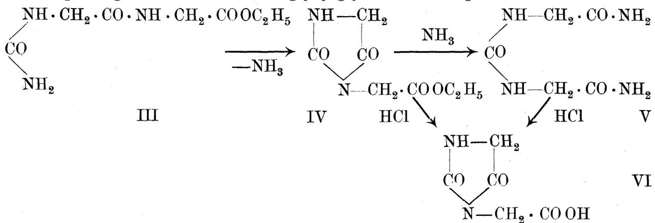
Durch Einwirkung von Ammoniak auf diesen Ester IV wird das Carbamidodiessigsäurediamid V erhalten, das seinerseits durch saure Hydrolyse wieder in die Hydantoin-3-essigsäure VI übergeht. Dieselbe zeichnet sich durch grosse Säurebeständigkeit aus. Durch Kondensation derselben mit Benzaldehyd und nachherige Hydrierung gelingt es, das Hydantoinderivat zu gewinnen, das dem Anhydrid des Carbonyl-phenylalanin-glycins entspricht, das ebenfalls ausserordentlich säurebeständig ist.
