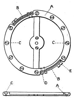
Balancier breveté à affixe compensateur A, anneau monométallique sans coupure, de teneur correspondante aux propriétés du spiral. — B, segment bimétallique de l'affixe compensateur. — C, série de vis noyées dans la serge pour parfaire l'équilibre et le moment d'inertie. — D, vis fixant la bilame. — E, vis compensatrices transportables.
