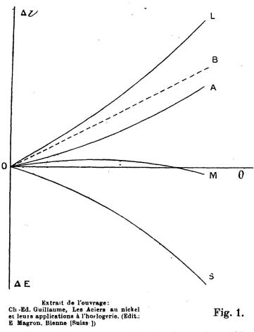
Cause de l'erreur secondaire des chronomètres (OS fonction perturbatrice du spiral; OB fonction compensatrice du balancier acier-laiton).
