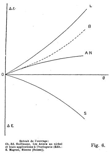
Correction de l'erreur secondaire des chronomètres (OB fonction perturbatrice du spiral, OB fonction compensatrice du balancier intégral).
