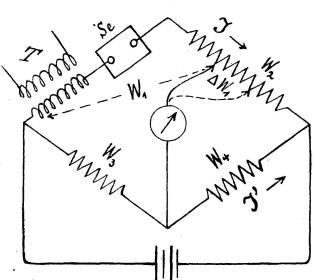
$W_p$  den Selenwiderstand bei einer Klemmspannung von P Volt an der Zelle,  $W_o$  den Widerstand in stromlosem Zustand. ksei als elektrischer Spannungskoeffizient bezeichnet.
