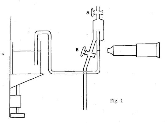
recherches) consiste à faire communiquer l'un des bouts du tube (celui de gauche dans notre figure) avec l'eau contenue dans un récipient à grande surface. Ce récipient peut être déplacé dans le sens vertical à l'aide d'une vis micrométrique. Le petit ménisque (dans le tube de droite) est pointé par un microscope. C'est sur ce petit ménisque que l'on fait agir la pression que l'on veut mesurer (ou le champ magnétique dont ont veut étudier l'effet sur le liquide). On observe tout d'abord
