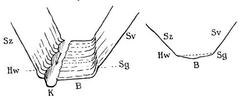
Fig. 1. Links (erhöht gezeichnetes) Sihlbett bei Niederwasser unterhalb Haslaubsteg; rechts gewöhnliches, abgeschrägtes Flusserosionsbett. Hw B Sg trogartiges U-tal (Schliffbett) mit Hochwasserzone Hw = Schliffgrenze Sg; K Kolk mit Wandresten von Erosionskesseln; Sz Splitterzone = Böschungen Sv des eigentlichen V-tales.
