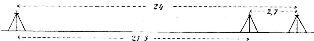
ca. 21,3 m zu messen, so wird man am einfachsten erst den 24 m langen Draht nochmals anlegen, damit über den Basisendpunkt hinaus messen und von dem neugestellten Stativ die Entfernung bis zu dem über dem Basisendpunkt aufgestellten Stativ von ca. 2,7 m mit dem Stahlband bestimmen. Oder wenn etwas
