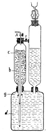
Flasche d schlierenförmig auszubreiten. Auf diese Weise entsteht eine Säurezirkulation, dadurch herbeigeführt, dass oben die schwere Salzlösung beständig durch das Trichterrohr abfliesst und dafür bei g die spezifisch leichtere Säure in das Gefäss b eindringt und hier das Zn bezw. FeS angreift.
