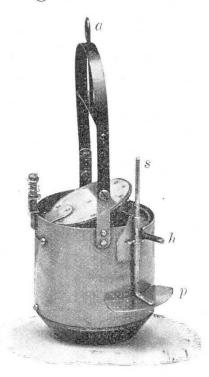
selben. Er besteht im wesentlichen aus zwei Hohlzylindern, einem schweren unteren, scharf in den Schlamm einschneidenden Endstücke, einer obern und einer untern Abschlussvorrichtung, einem verstellbaren Auslöseapparat und einer umlegbaren Aufhängevorrichtung. — Bevor der Apparat an einer starken, oben bei a befestigten Leine in die Tiefe versenkt wird, stellt man die mittels der Stange s verschiebbare Auslösevorrichtung je nach der Höhe der Schlammsäule, die man ausheben
